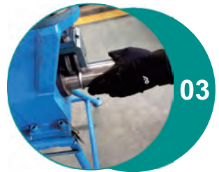
Use AQUApipe lugging machine to lug the pipe.
